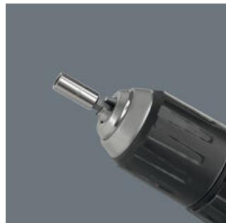
Universalhalter für die Aufnahme von Bits mit 1/4"-Außensechskant mit 1/4"-Außensechskantantrieb. Edelstahlhülse für besonderen Korrosionsschutz. Der Sprengring garantiert optimalen Sitz des Werkzeugs im Halter. Der starke Dauermagnet hält die Bits bombenfest. Passend für Schraubermaschinen mit Aufnahme nach DIN ISO 1173-F 6,3.
