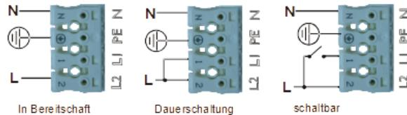
Die Reihenfolge der Netzeitungsbezeichnung kann von der hier gezeigten Darstellung abweichen. Nach dem Anschluss an das Netz wird der Inbetriebnahmetest gestartet und an der LED der Statusanzeige angezeigt (siehe Testbetrieb).
