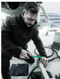
Die Zyklop Comfort Knarre ermöglicht durch ihre Feinverzahnung mit 80 Zähnen einen kurzen Rückholwinkel von nur 4,5°.
