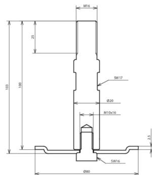
Fußstück mit Flanschplatte für Tiefenerder schraubar zur Vermeidung des Einsinkens in das Erdreich.
