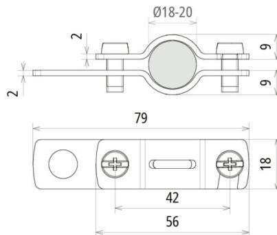
Zum Absteuern des elektrischen Feldes der HVI light plus Leitung im Bereich des Endverschlusses oder anderen Fällen.
