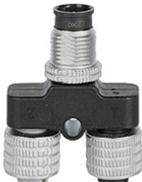
Steckverbinder, T-Adapter, IP67, 2x M12 Buchsenstecker, 5-polig, A-codiert auf M12 Stiftstecker, 5-polig, A-codiert, interne Verdrahtung 1:1 für alle 5 Signale, zum Anschluss zweier PSEN an PSS67.
