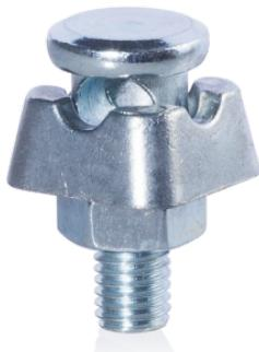
ASK1; für Stab-/Kreuzerder, 1-fach, für Rundleiter Ø 8-10 mm; Anschlussklemmen; Material: Stahl, verzinkt
