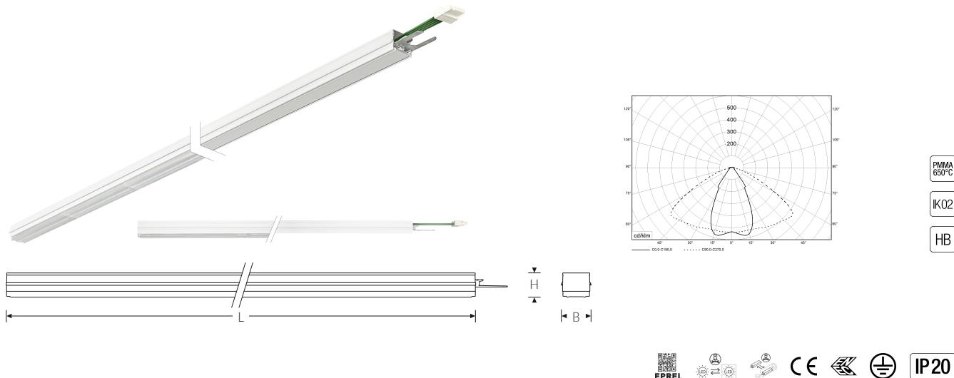
TRF LED-Lichtleiste mit einreihiger, linearer Lichtoptik aus PMMA, dimmbar. Medium Beam, 60° Abstrahlwinkel. Tragschiene und Lichteinsatz sind eine Einheit. Gehäuse aus profiliertem Aluminium mit Durchgangsverdrahtung, Stecksystem und Schnellverschlüssen.
