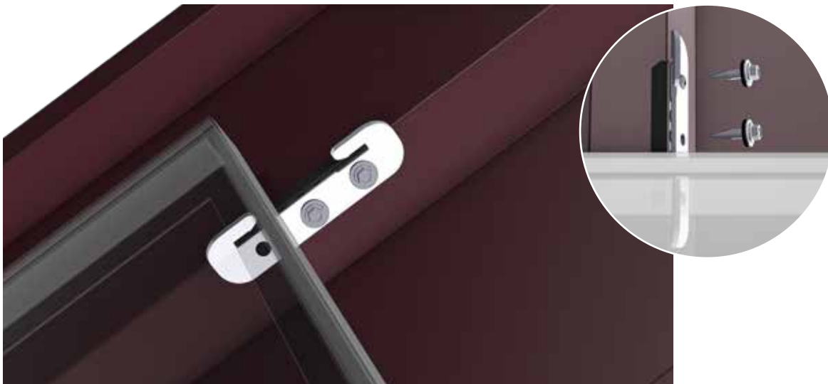
Befestigung von EcoRapid am Modulfeldrand mit zwei Dünublechschrauben
