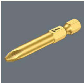
A steht für Aviation (Luftfahrt). A-Bits sind besonders harte Bits mit scharfkantigem Profil, welches z. B. bei mit Farblack vollgesetzten Schraubenprofilen die Farbe aufbrechen lässt und somit eine sichere Kraftübertragung zwischen Bit und Schraube gewährleistet.
