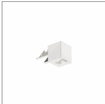
Silica® 21Sensor-Modul PC3-S, Slave, lokale Steuerung, dimmbar, Montageanordnung: Einzel-/Bandanordnung, Montageart: Einstektmontage, Montageort: an der Leuchte, aus Alu-Strangpreßprofil, Schutzart (gesamt): IP20, Schutzklasse (gesamt): SK I (Schutzerdung), Prüfzeichen: CE, 1 x PIR-Bewegungssensor, 1 x Lichtsensor, Verpackungseinheit: 1 Stück
