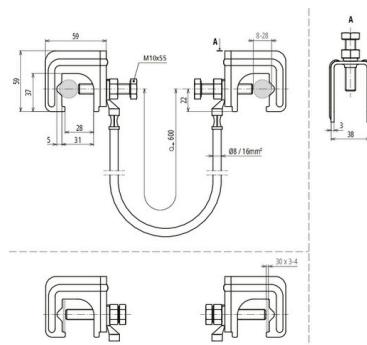
Überbrückungsgarnitur bestehend aus Verbindungsleitung mit zwei angeschlossenen Verbindungsklemmen.
