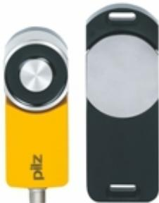
Magnetisches, sicheres Schutztürsystem für Anwendungen bis SIL 3/PL e/Kat. 4. Magnetische Haltekraft 500 N (Prozessschutz). Codierung: codiert, 8-pol. M12 Stecker, 4 LEDs, IP67, Verpackungsinhalt = Sensor mit Standard-Betätiger
