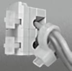
Um die Sicherheitsanforderungen zu erfüllen müssen die Drähte mit einem Kabelbinder gesichert werden, siehe Bild.
