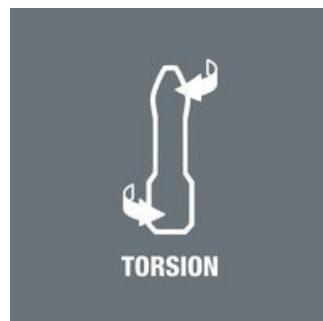
Torsion-Bits (T) sorgen für die Abfederung von Drehmomentspitzen in der Torsionszone. Dadurch wird vorzeitiger Verschleiß vermieden, die Lebensdauer des Bits wird erhöht.
