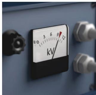
Die Prüfung des Werkzeugs auf Durchschlagsfestigkeit bei 10.000 Volt gibt dem Anwender die beruhigende Gewissheit, dass sein Werkzeug auf seine wichtigste Eigenschaft, die Isolation, geprüft worden ist. Wera VDE-Werkzeuge werden Stück für Stück dieser Prüfung unterzogen. Sicherer Arbeiten bis 1.000 Volt ist somit garantiert.
