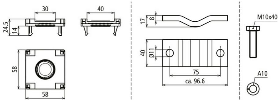
Adapter für zündfunkenfreie Ex-Potentialausgleichsschiene PAS EX zum Anschluss eines Flachleiters. Einsatz in explosionsgefährdeten Bereichen Ex-Zonen 1 und 2 (Gase, Dämpfe, Nebel) bis Explosionsgruppe IIC sowie Ex-Zonen 21 und 22 (Stäube). Einsatz sowohl im Innenbereich als auch im Außenbereich zulässig.
