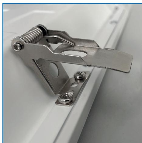
**Montagehinweis:** Schrauben auf der Panel-Rückseite lösen, anschließend die Halteklammer positionsgerecht einsetzen und mittels mitgelieferter Befestigungsschrauben anbringen.
