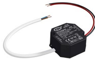
Der kurzschlussfeste Sicherheitstransformator lässt sich auf Grund der höheren Schutzart problemlos im Außenbereich einsetzen, kann aber z. B. auch beim Möbelbau verwendet werden, da die MM-Kennzeichnung gegeben ist. Die Anschlussleitungen haben eine Länge von 15cm primärseitig und 15cm sekundärseitig. Technische Daten: Versorgungsspannung: 220-240V/AC, ta: -20°C - 50°C, tc: 80°C, Powerfaktor 0,95.
