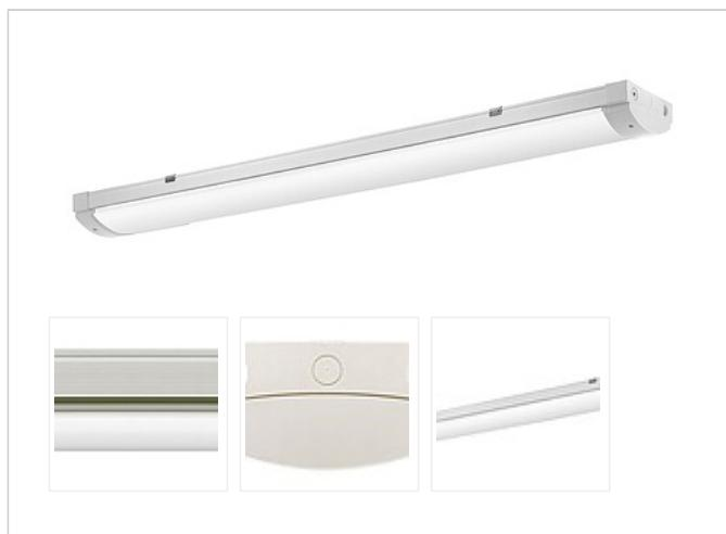
LED Leuchte in runder Bauweise mit effizienten MID-Power LEDs, LED Einheit komplett wechselbar, Konverter in Leuchte integriert, flaches, stabiles GFK-Polyestergehäuse, schlagzähe Abdeckung aus PRACHTOPAL, Ein-Mann-Montage mit variablen Befestigungsabständen durch PRACHT-KLAMMER-SYSTEM
