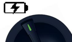
Das nebenstehende Piktogramm wird auf dem Display eingeblendet, falls keine Verbindung zum Netz besteht oder der Netzschalter nicht auf **EIN „1“** steht.
