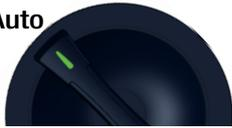
In der Drehschalterstellung **AUTO** werden alle im Gerät vorhandenen Prüfsequenzen angezeigt.
