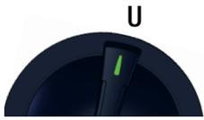
Die Messfunktion **U** bietet die Möglichkeit sowohl Gleich- als auch Wechselspannung und die zugehörige Frequenz zu messen.
