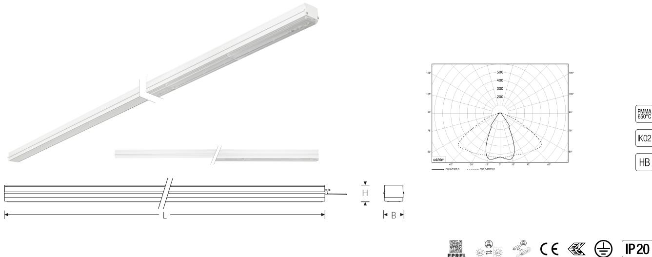
TRF LED-Lichtleiste mit einreihiger, linearer Lichtoptik aus PMMA. Medium Beam, 60° Abstrahlwinkel. Tragschiene und Lichteinsatz sind eine Einheit. Gehäuse aus profiliertem Aluminium. Mit Schnellverschluss, ohne Durchgangsverdrahtung. Mit montiertem Enddeckel. Verwendbar als Einzelleuchte oder als Endmodul im Lichtband.
