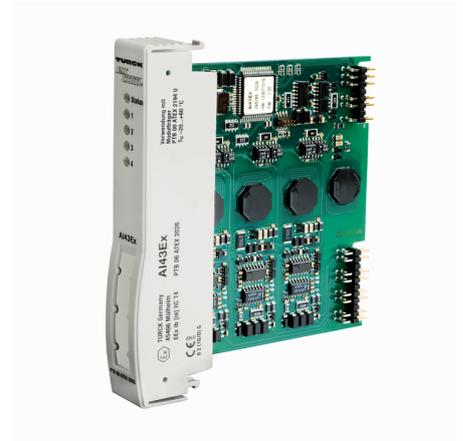
Das analoge Eingabemodul AI43Ex dient zum Anschluss von Potenziometern in 3- oder 4-Leiter-Technik. Bei der Verwendung von 3-Leiter-Potenzimetern muss an den Anschlussklemmen am Modulträger eine Brücke gesetzt werden. Widerstandsmessungen, also die Auswertung von Potenziometern mit 2-Leiter-Anschluss, sind nicht möglich.
