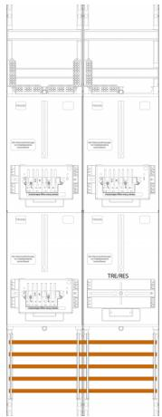
**Zählerfeld Z16ZR6-ZSK, H=1350mm, 2-feldrig, 3-3.HZ, 3 ZSK-Set, 1 TRE**
