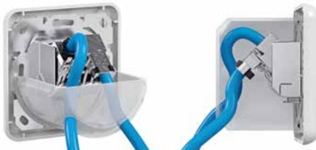
Wird das Kabel von unten in die Geräteeinbaudose eingeführt, bleibt dem Kabel bei Modulen mit gerader Einführung in Schrägauslassdosen nicht genügend Platz: Die Folge sind Übertragungsprobleme durch geknickte Kabel. Das AMJ-SL 4x90 lässt dem Kabel den Platz, den es benötigt.
