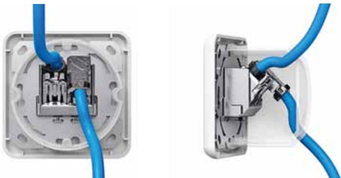
Module mit geradem Kabeleinlass eignen sich in Schrägauslassdosen nur für die Kabel-einführung von oben. Beim AMJ-SL 4x90 ist die Kabelzuführung von unten möglich.
