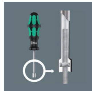
Bei Verschraubungen an Gewindestangen sind Schraubendreher mit Hohlschaft nützlich, denn die Gewindestange kann in den hohen Schaft des Schraubendrehers eindringen und die Schraubenmutter betätigt werden.
