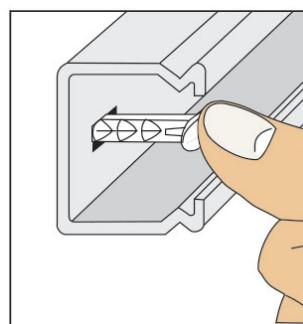
Drei verschiedene Längen für rationelles Arbeiten auf Untergründen mit oder ohne Putz. Durch einfachen Daumendruck wird der Dübelstecknagel ins Bohrloch gedrückt. Damit sitzt der Kabelkanal sicher und fest.
