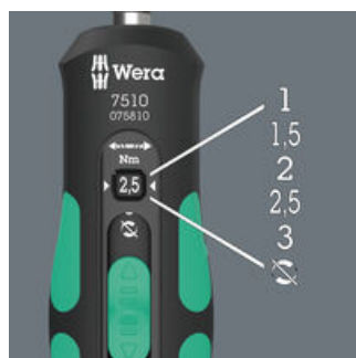
Fünf wählbare Anzugsdrehmomente (1,0; 1,5; 2,0; 2,5; 3,0 Nm) und eine Fest-Stellung (Torque Lock) für unbegrenzte Löse- und Anzugsmomente.
