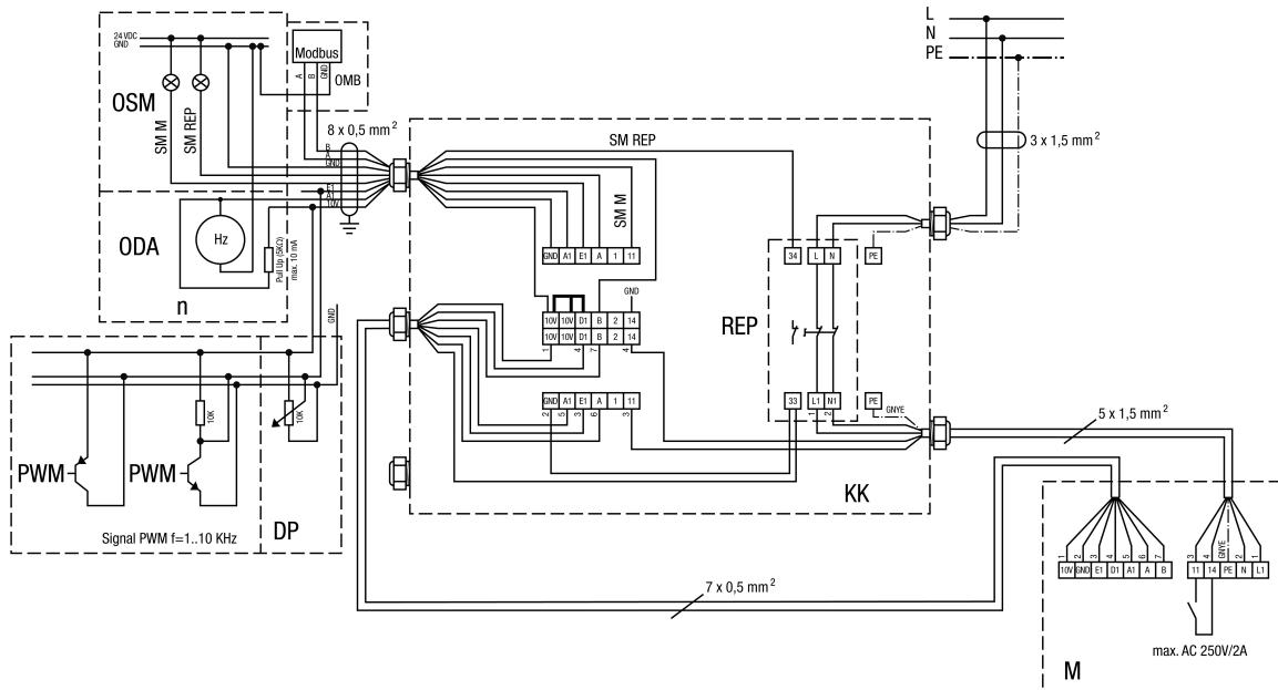
L/L1, N/N1 - Spannungsversorgung 230V/50Hz
