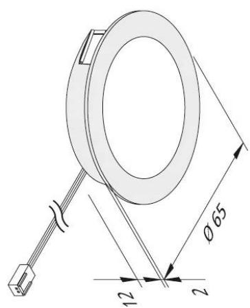
bei Dämmung Abstandshalter min. 50 mm verwenden
