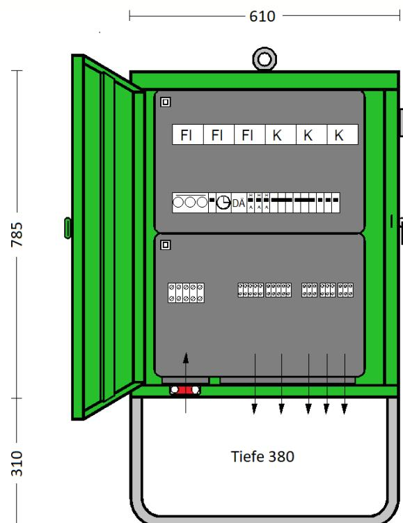
**ELEKTRA** - Verteilerschrank im Gehäuse aus verzinktem Stahlblech,
