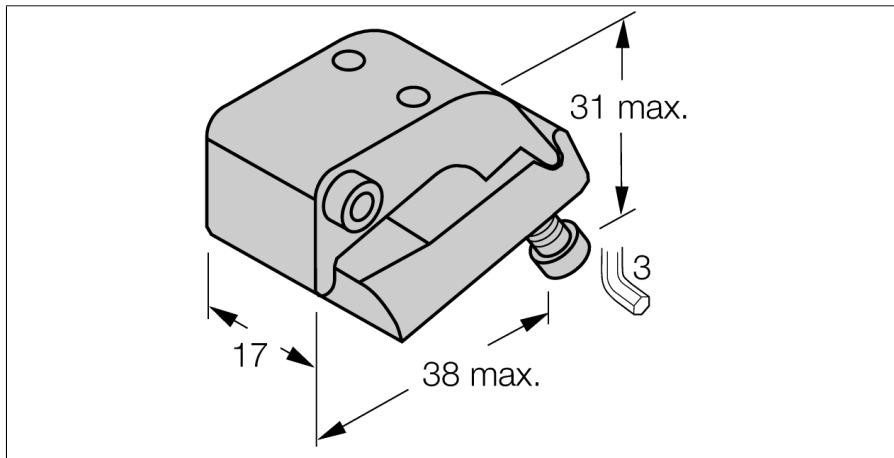
**Montage Zubehör Magnetinduktiver Sensor zur Montage an Zugankerzylinder für Zylinder Durchmesser 50...125mm, Aluminium eloxiert**
