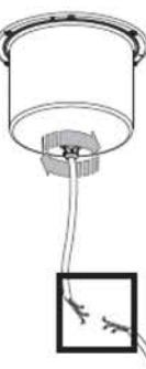
Der BES III/7 LED und BES XI/7 LED werden bereits mit einem 1m langem Kabel H07RN-F 3 x 1,5mm<sup>2</sup> geliefert. Die Kabeldurchführung (PG 11) ist generell für Kabel 5-10mm geeignet. Wir weisen Sie darauf hin, dass die Gewährleistung entfällt, sofern Sie ein anderes Kabel anschließen, da wir den ordnungsgemäßen Anschluss des Kabels und damit die Dichtheit der Bodeneinbaustrahler nicht sicher stellen können.
