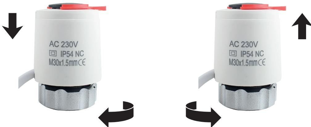
Schrauben Sie den Stellantrieb im Uhrzeigersinn auf das Ventil. Mit der Hand festziehen. Schließen Sie den Strom 3 – 5 Minuten lang an. Entfernen Sie das rote Teil.
