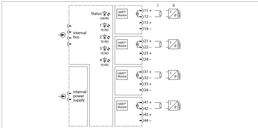
Das Ausgangsmodul AOH401-N dient zum Anschluss von analogen Aktuatoren wie Stellventilen oder Prozessanzeigen.
