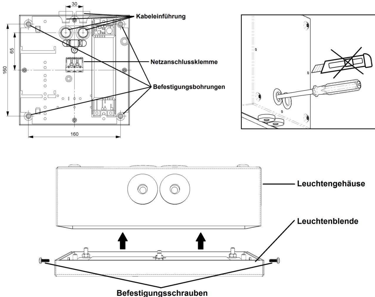
1. In die Montageebene vier Befestigungslöcher laut Bohrplan bohren und die Dübel (nicht im Lieferumfang enthalten) einschlagen.
