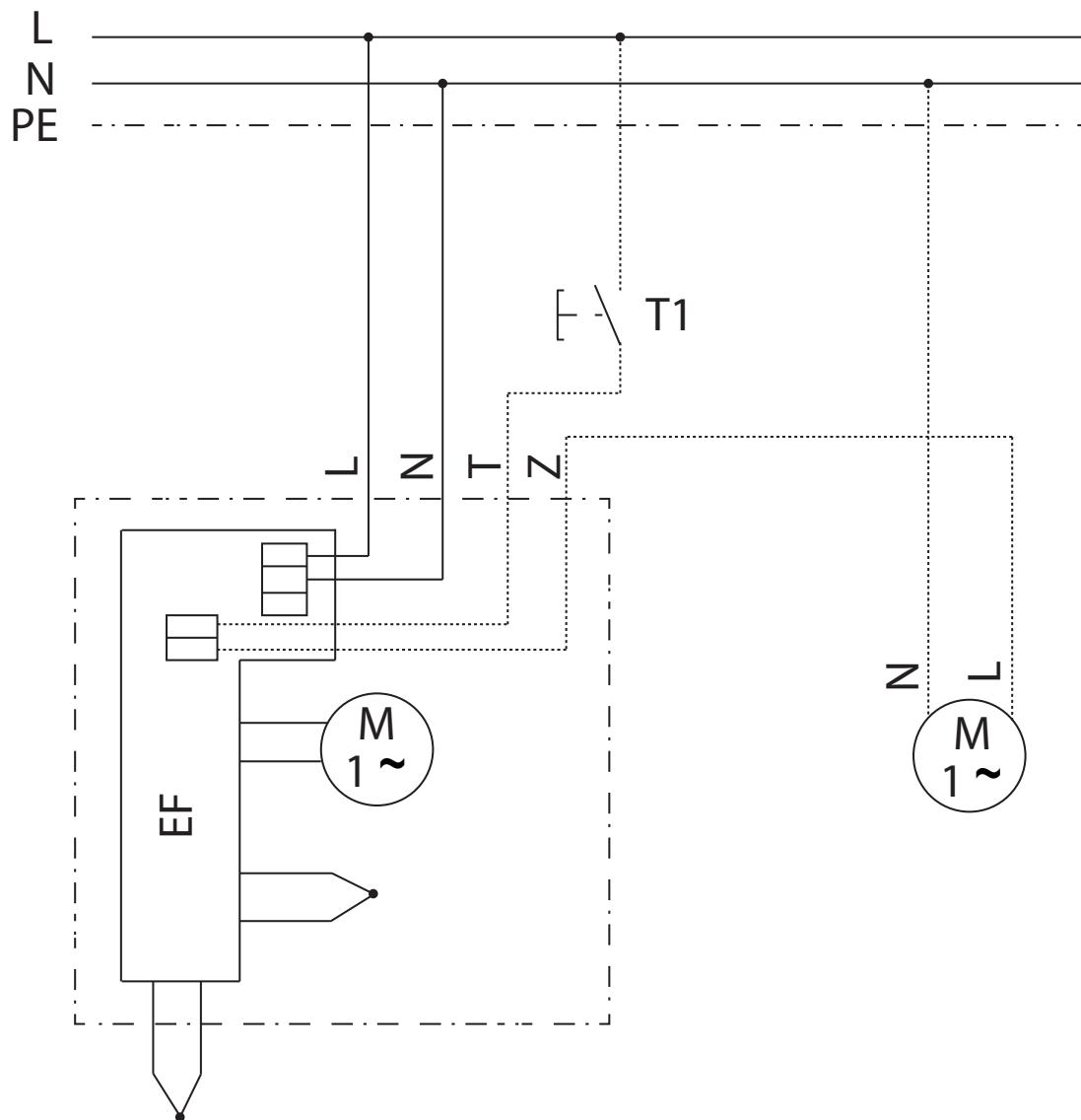
EF - Entfeuchtungssteuerung
