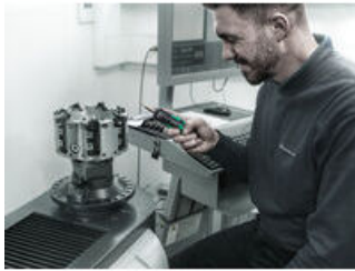
Drehmomentschraubendreher mit Schnelleinstellung
