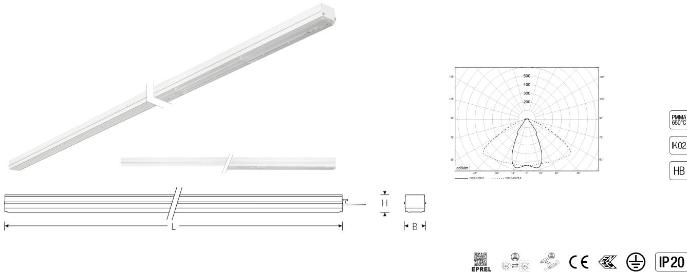
TRF LED-Lichtleiste mit einreihiger, linearer Lichtoptik aus PMMA, dimmbar. Medium Beam, 60° Abstrahlwinkel. Tragschiene und Lichteinsatz sind eine Einheit. Gehäuse aus profiliertem Aluminium. Mit Schnellverschluss, ohne Durchgangsverdrahtung. Mit montiertem Enddeckel. Verwendbar als Einzelleuchte oder als Endmodul im Lichtband.
