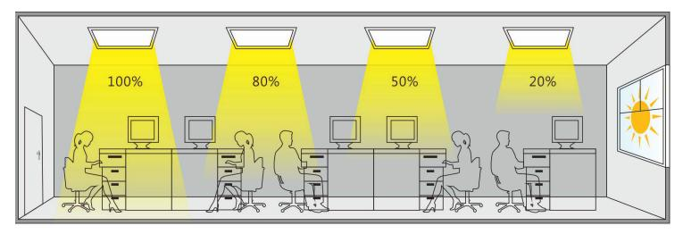
Der Konverter misst selbstständig die Helligkeit der Umgebung. Anschließend wird das gewünschte Beleuchtungsniveau in Abhängigkeit vom vorhandenen Umgebungslicht eingestellt und automatisch eingehalten.
