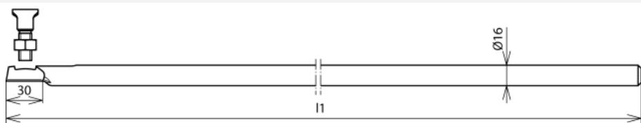
Fangstange mit angeschmiedetem Lappen, zum Schutz von Dachaufbauten, Kaminen usw., für die Befestigung mit Stangenhaltern / Distanzhaltern inkl. KS-Schraube für den Anschluss von Rundleitern 7-10 mm.
