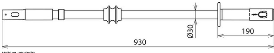
Isolierstange IS 36 STK. Mit Steckkupplung beidseitig zum Aufstecken von Verlängerungen, Arbeitsköpfen oder Adapters. Einzelteil zum Isolierstangenset IS STK.
