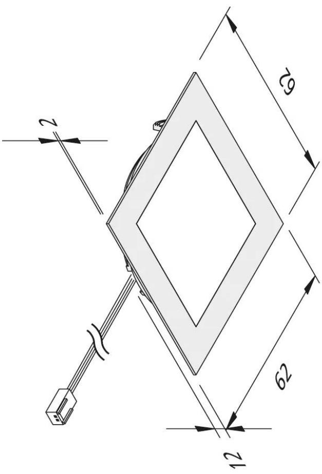
bei Dämmung Abstandshalter min. 50 mm verwenden
