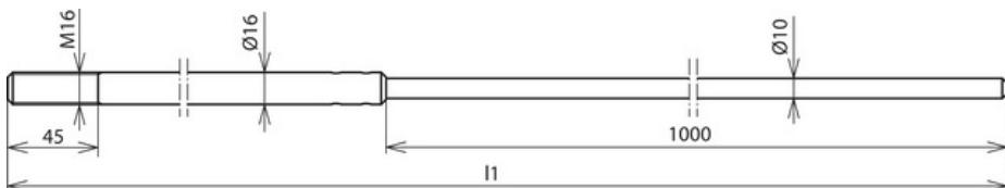
Fangstange mit Verjüngung (1000 mm) Gewinde M16, zum Schutz von Dachaufbauten, Kaminen usw., speziell für Betonsockel (17 kg) mit Gewindeadapter und zusätzlicher Befestigung mit Distanzhalter.
