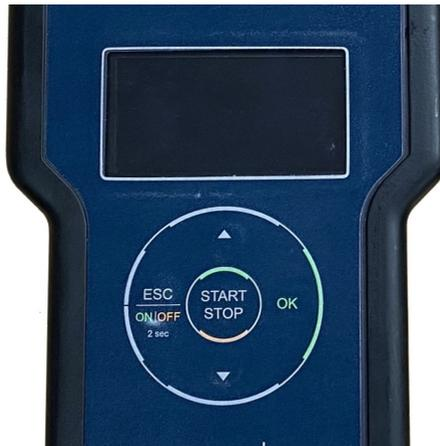
Figure 4: Folientastatur mit Bedienfeld und Bildschirm
