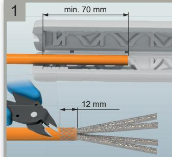
Den Kabelmantel min. 70 mm absetzen. Schrimgeflecht über den Kabelmantel zurückziehen und kürzen.
