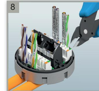
Paarschirmung auf Höhe des Kunststoffrings entfernen und Adernpaare nach Farbcode aufsetzen.
