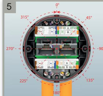
Platineneinheit einclipsen. Positionierung in 8x 45° Schritten möglich.
