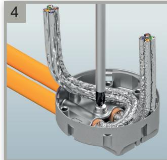
Kabel in Gehäuse einführen, fixieren und Aderpaare positionieren.
