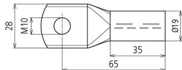
Presskabelschuh nach DIN 46235 mit Nickelsperrschiicht zur Vermeidung von Whiskerbildung.
