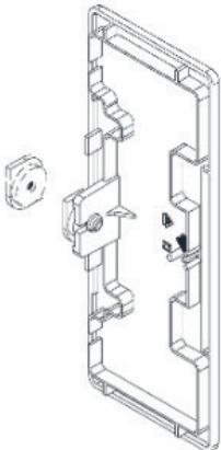
2. Den Enddeckel an das Kanalende ansetzen, sodass die Gleitmutter in die Befestigungsprofile (A) des Kanals eingeschoben werden kann.
