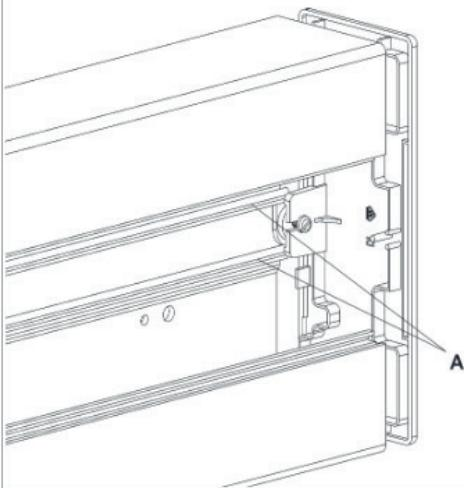
3. Den Enddeckel komplett aufschieben, anschließend wird die Schraube von vorne durch die Deckelloffnung angezogen.
