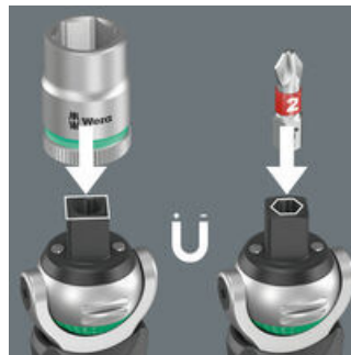
Die magnetische Direktaufnahme ist sowohl für 3/8"-Steckschlüsseleinsätze als auch für 1/4" Bits geeignet.
