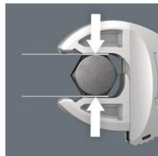
Die parallelen glatten Backen des Doppelmaulschlüssels Joker 6006 ermöglichen eine Flächenpressung und können dadurch das Verrunden der Mutter bzw. des Schraubenkopfes vermeiden, was bei der Kraftübertragung über Ecken auftreten kann.
